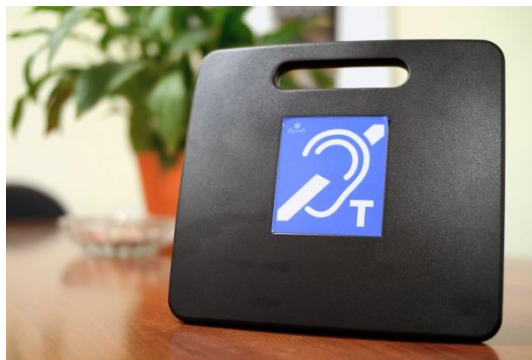
Sistema de inducció magnètica portàtil
